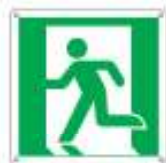
Uscita di emergenza a sinistra E001 ●
