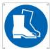
È obbligatorio indossare la calzatura di sicurezza M008 ●
