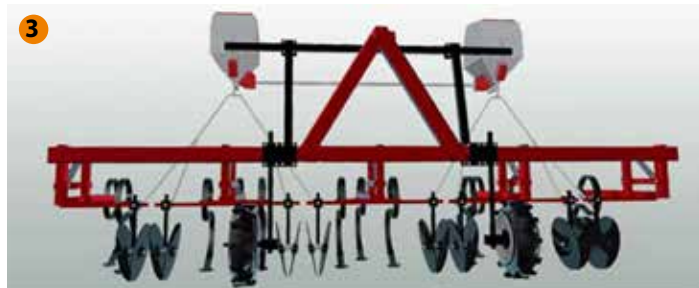
Figura 3: schema di montaggio di sarchiatore 4 file a telaio fisso, con installata attrezzatura per l'applicazione di ERCOLE. Gli interratori a doppio disco (coppia di interratori per ogni fila di mais) sono fissati tramite staffe sugli stessi elementi sarchianti standard su cui sono montate 3 molle elastiche con zappetta. Due microgranulatori standard, ciascuno dotato di 2 uscite che vengono sdoppiate per mezzo di un innesto a Y, servono a garantire la distribuzione fornendoli all'alimentazione agli 8 elementi interratori, tramite apposito tubo di calata.
