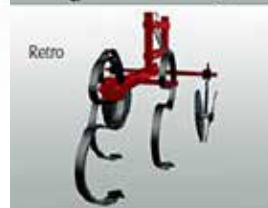
Figura 3: schema di montaggio di sarchiatore 4 file a telaio fisso, con installata attrezzatura per l'applicazione di ERCOLE. Gli interratori a doppio disco (coppia di interratori per ogni fila di mais) sono fissati tramite staffe sugli stessi elementi sarchianti standard su cui sono montate 3 molle elastiche con zappetta. Due microgranulatori standard, ciascuno dotato di 2 uscite che vengono sdoppiate per mezzo di un innesto a Y, servono a garantire la distribuzione fornendoli all'alimentazione agli 8 elementi interratori, tramite apposito tubo di calata.
